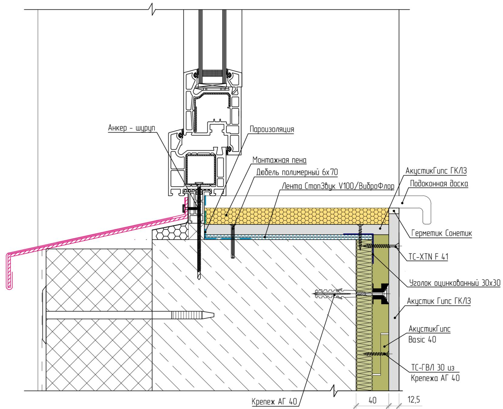
Примыкание облицовки стены к конструкции оконного блока,
