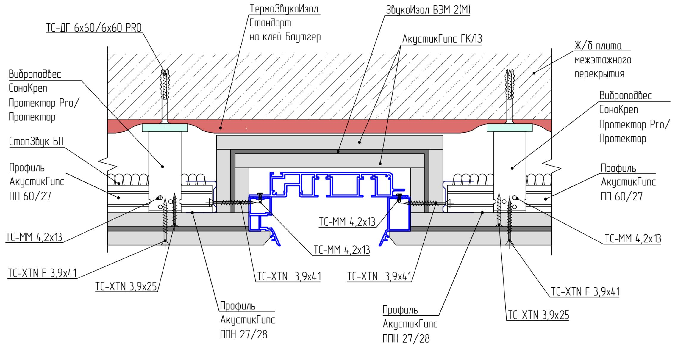
Устройство расширителя зазора и конструкционного профиля.
