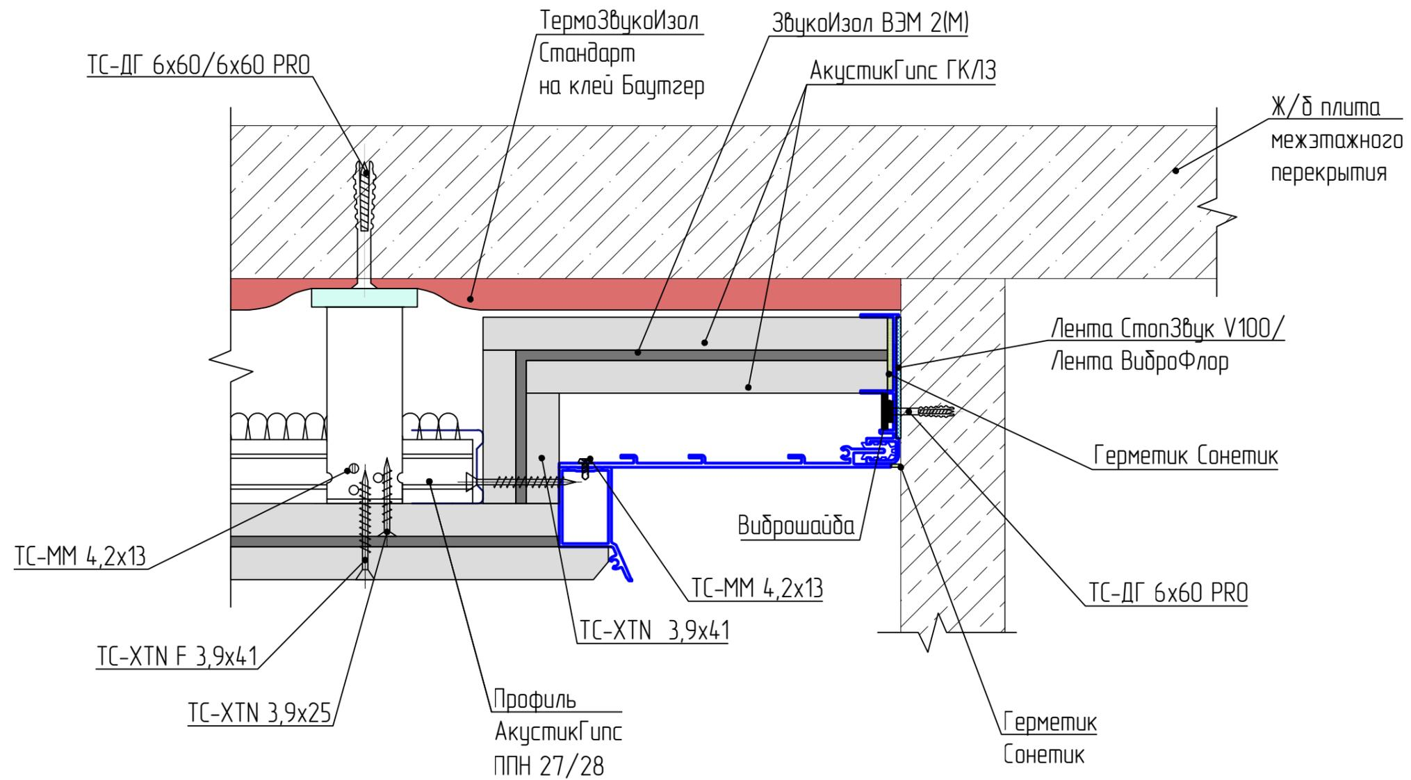
Устройство расширителя зазора, конструкционного профиля
