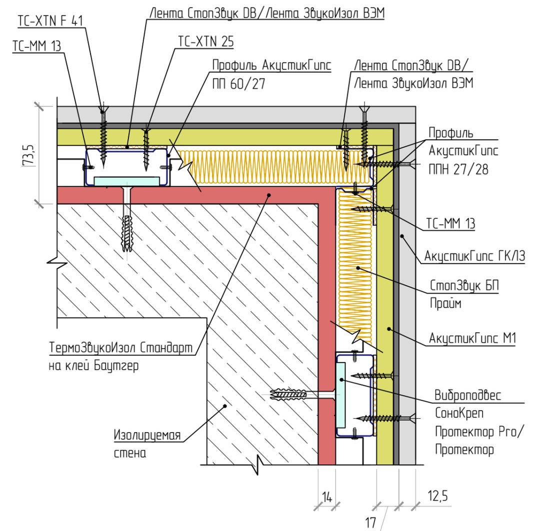
Внешний угол каркасных облицовок стен,
