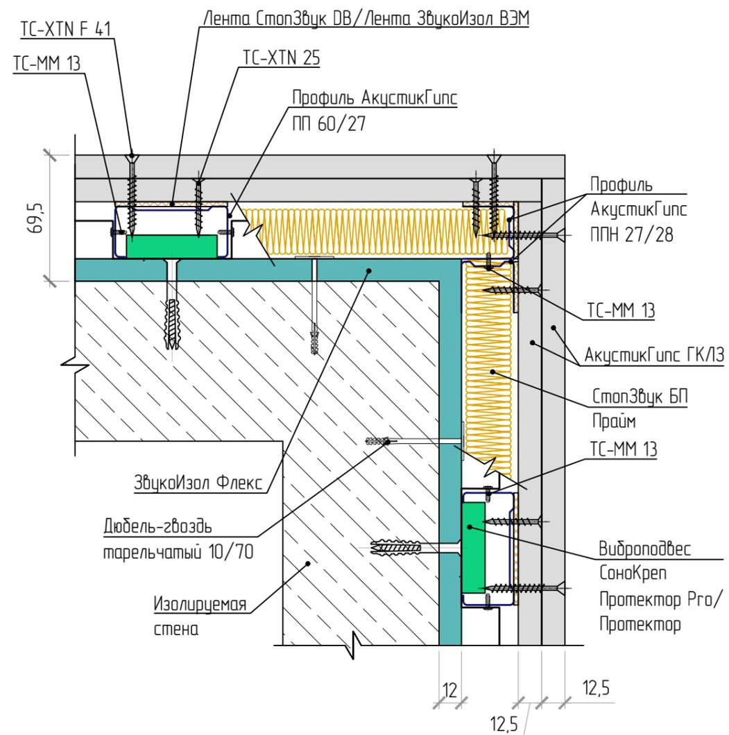
Внешний угол каркасных облицовок стен,
