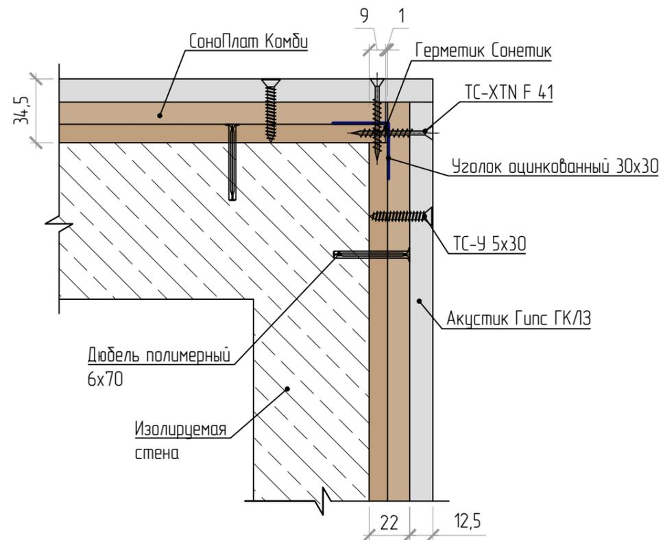
Внешний угол бескаркасных облицовок стен, тип ТС-2.6.1 (Слим Премиум)
