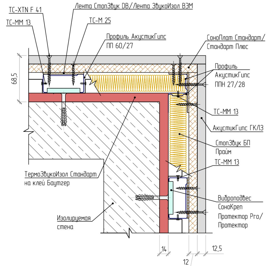
Внешний угол каркасных облицовок стен,
