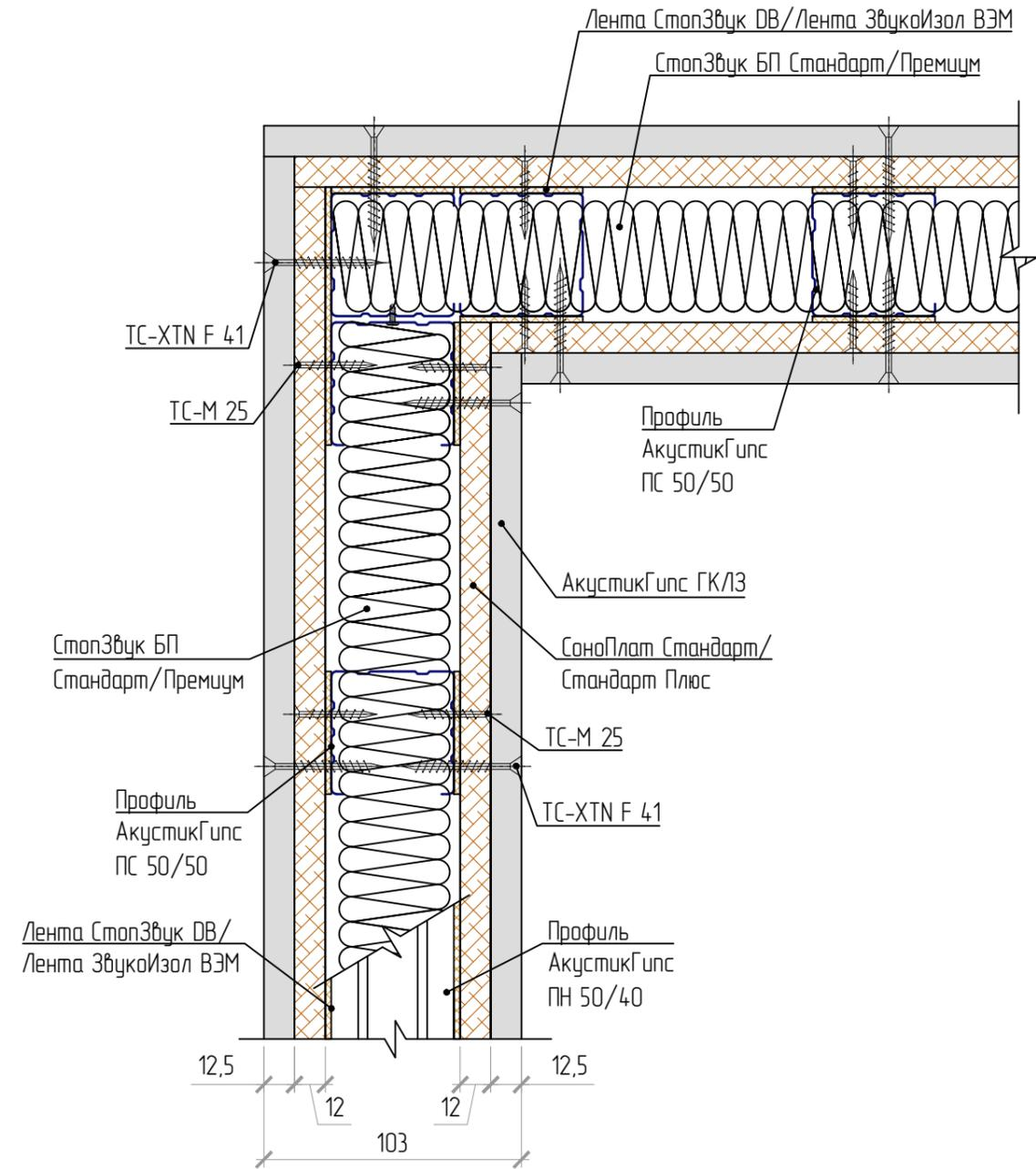
Внешний угол каркасных перегородок,
