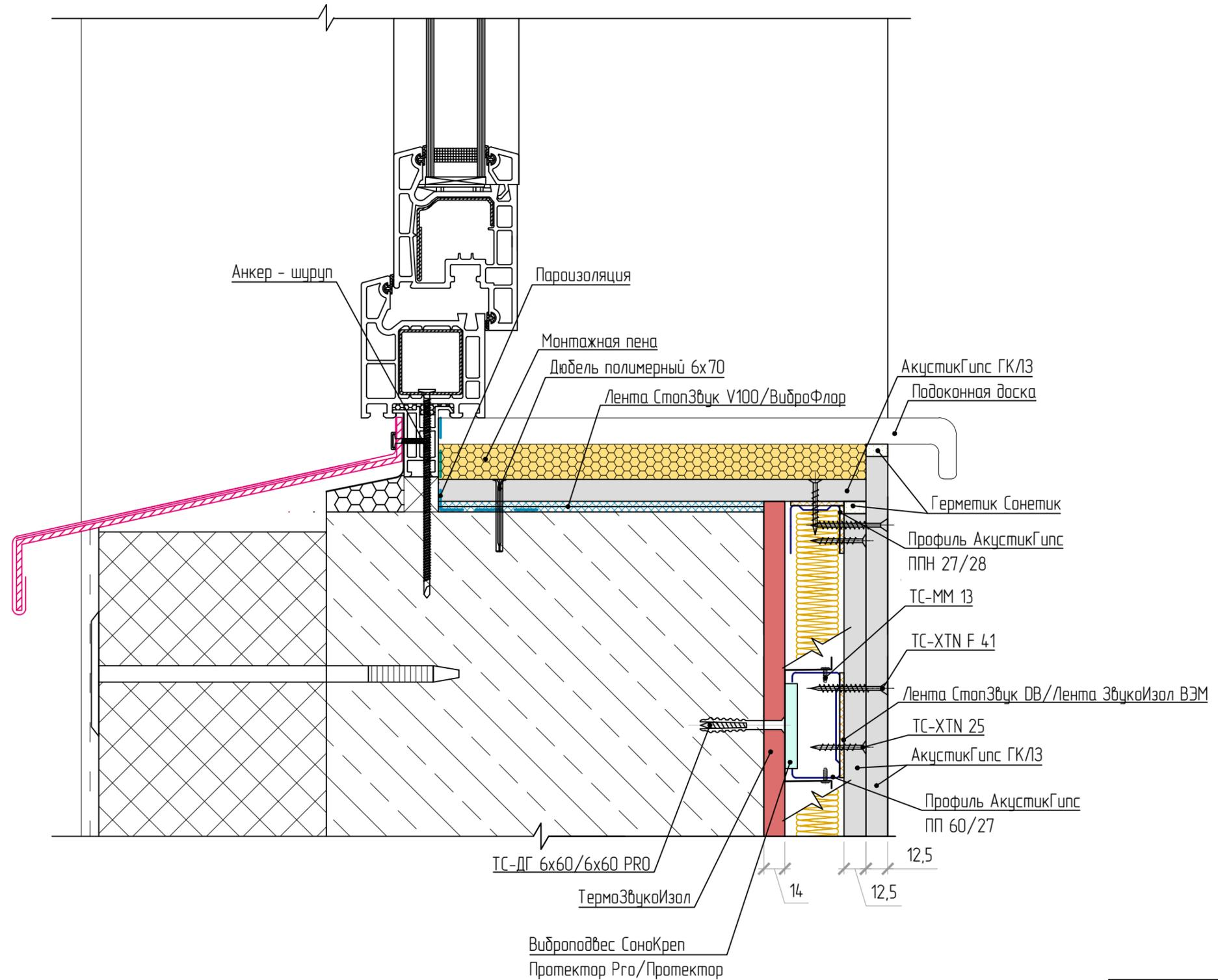
Примыкание облицовки стены к конструкции оконного блока,
