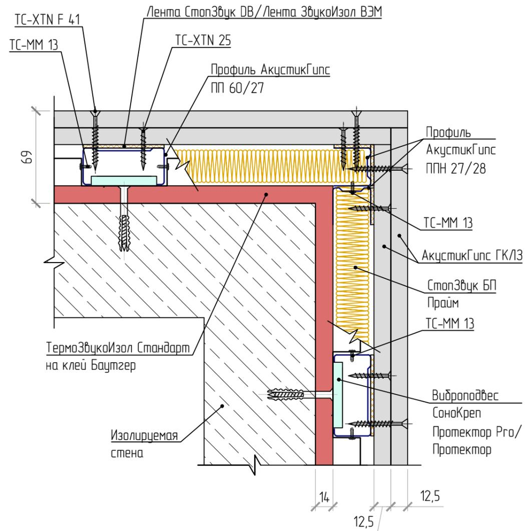
Внешний угол каркасных облицовок стен,
