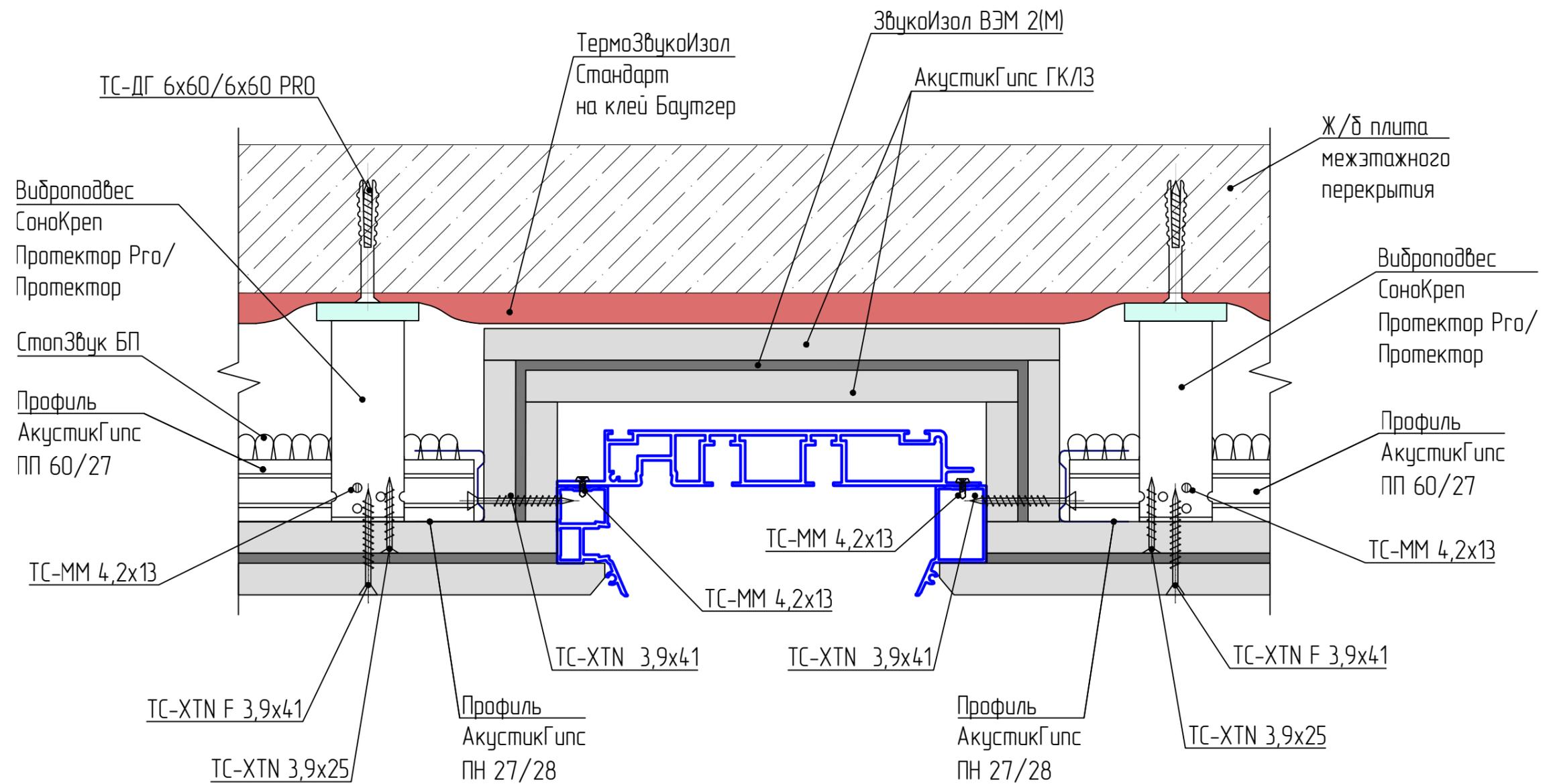
Устройство карнизного профиля шириной 115 мм и
