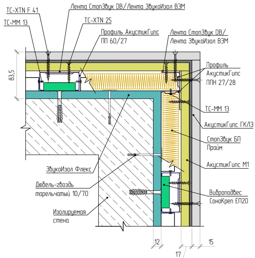
Внешний угол бескаркасных облицовок стен, тип ТС-2.6 (Слим П)
