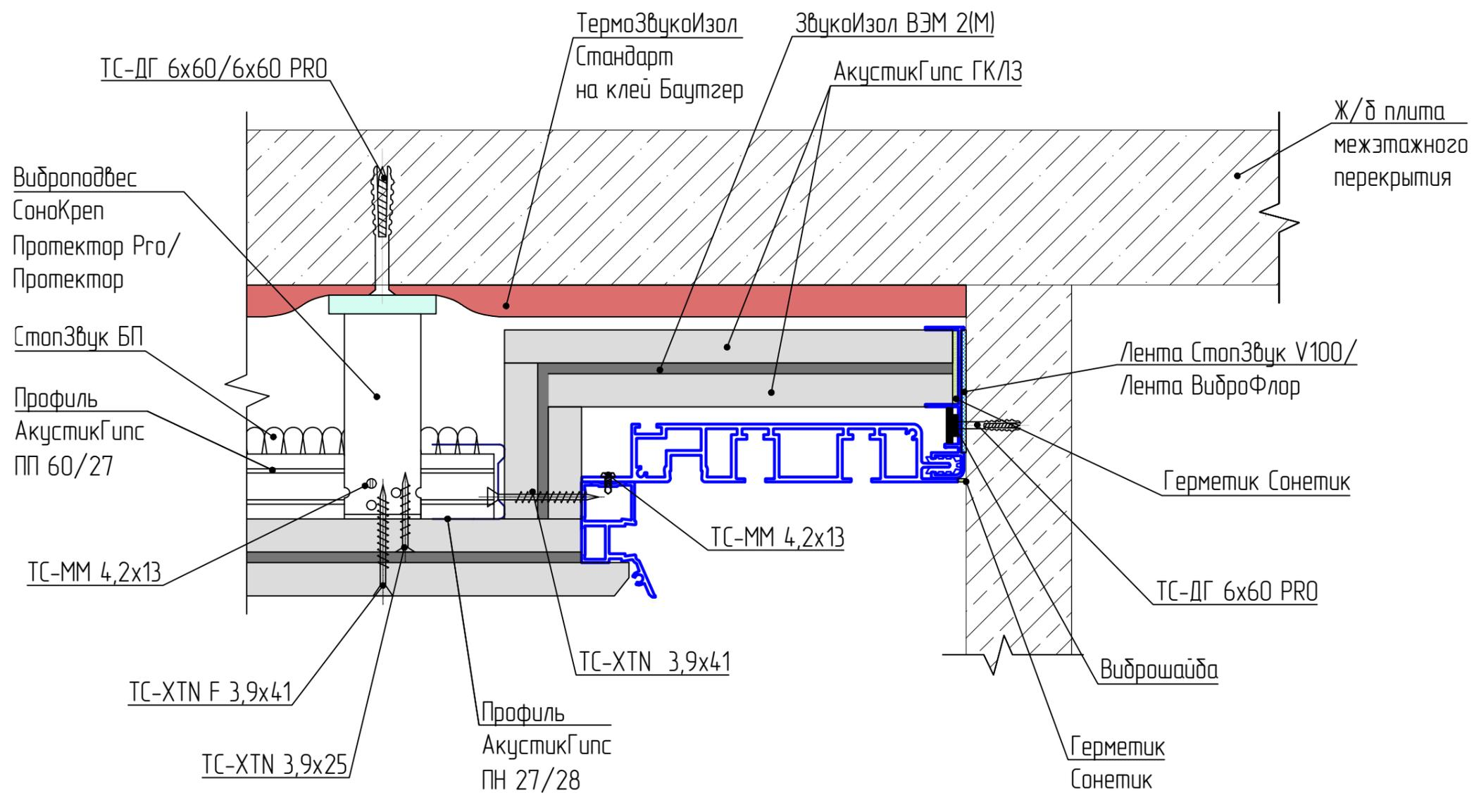
Устройство карнизного профиля шириной 115 мм и
