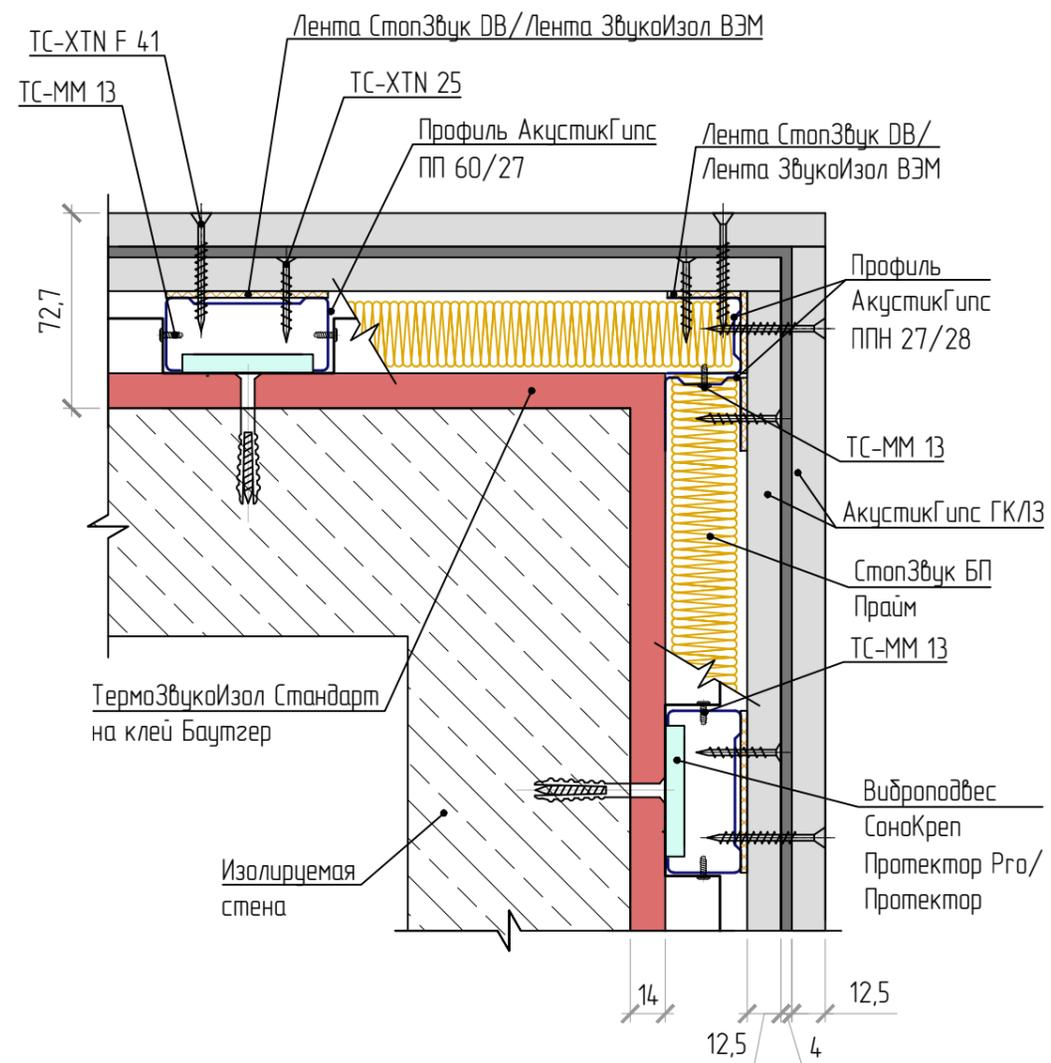
Внешний угол каркасных облицовок стен,
