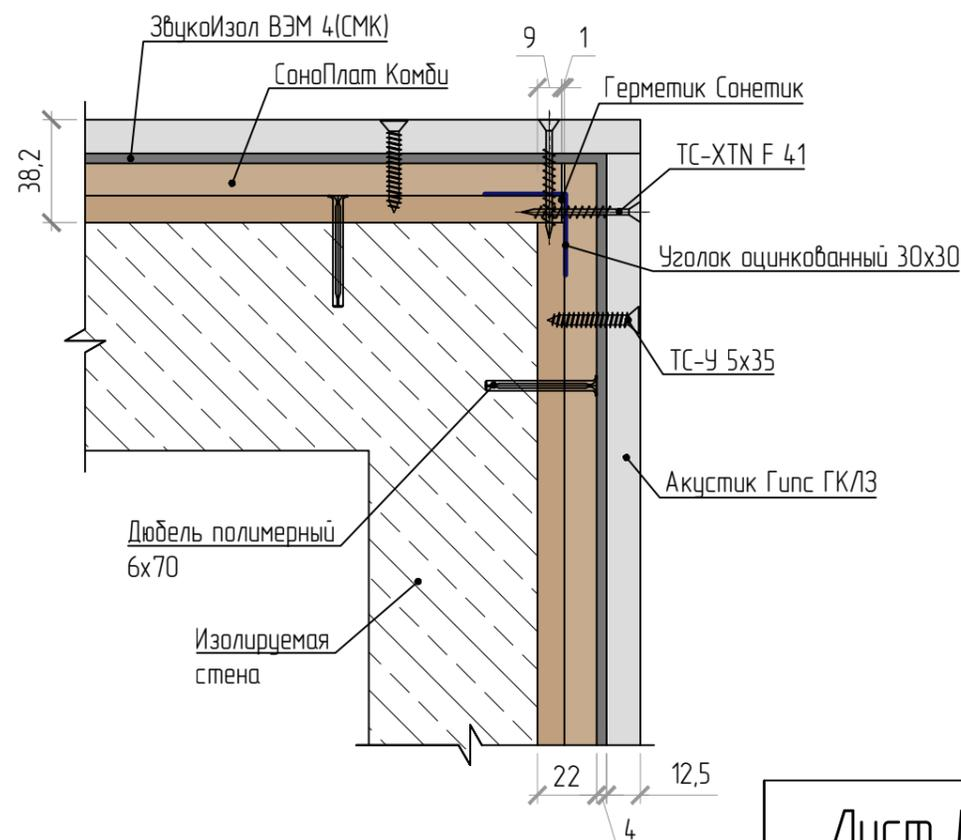
Внешний угол бескаркасных облицовок стен,
