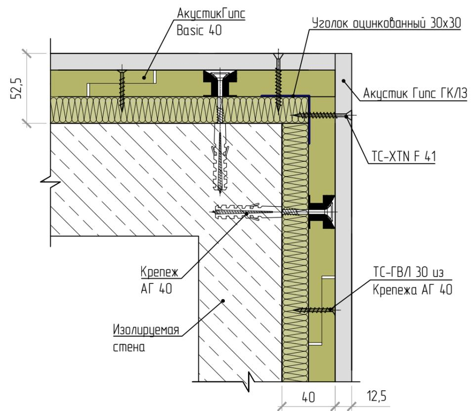
Внешний угол бескаркасных облицовок стен,
