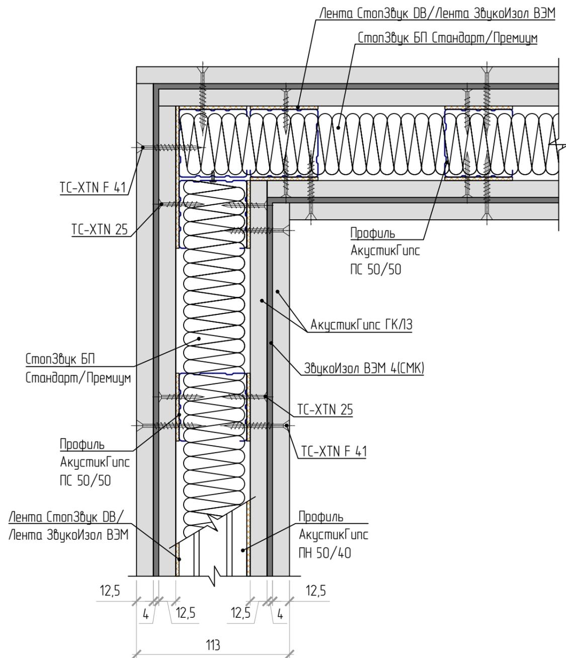
Внешний угол каркасных перегородок,
