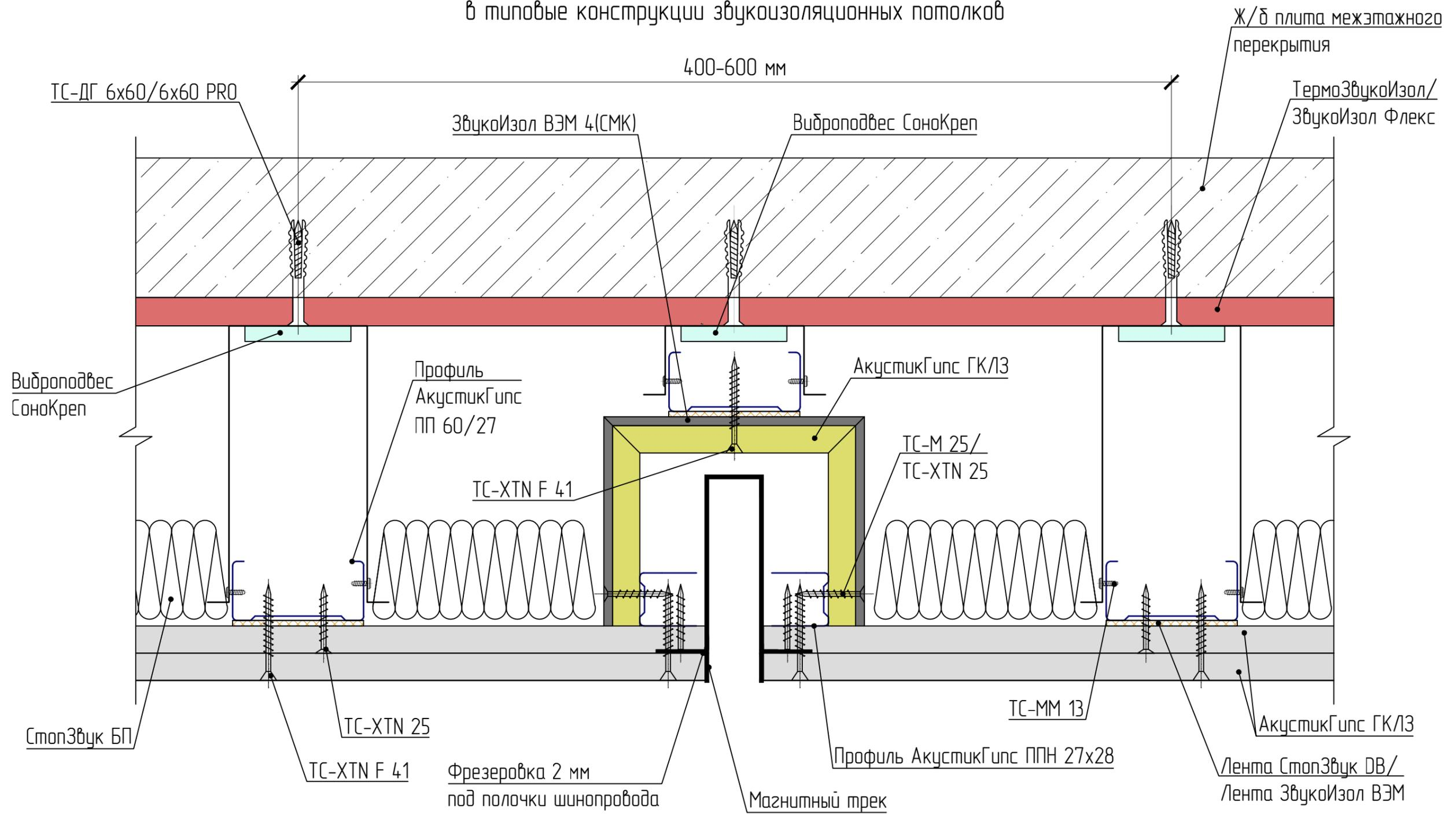
Устройство карнизного профиля шириной 140 мм и
