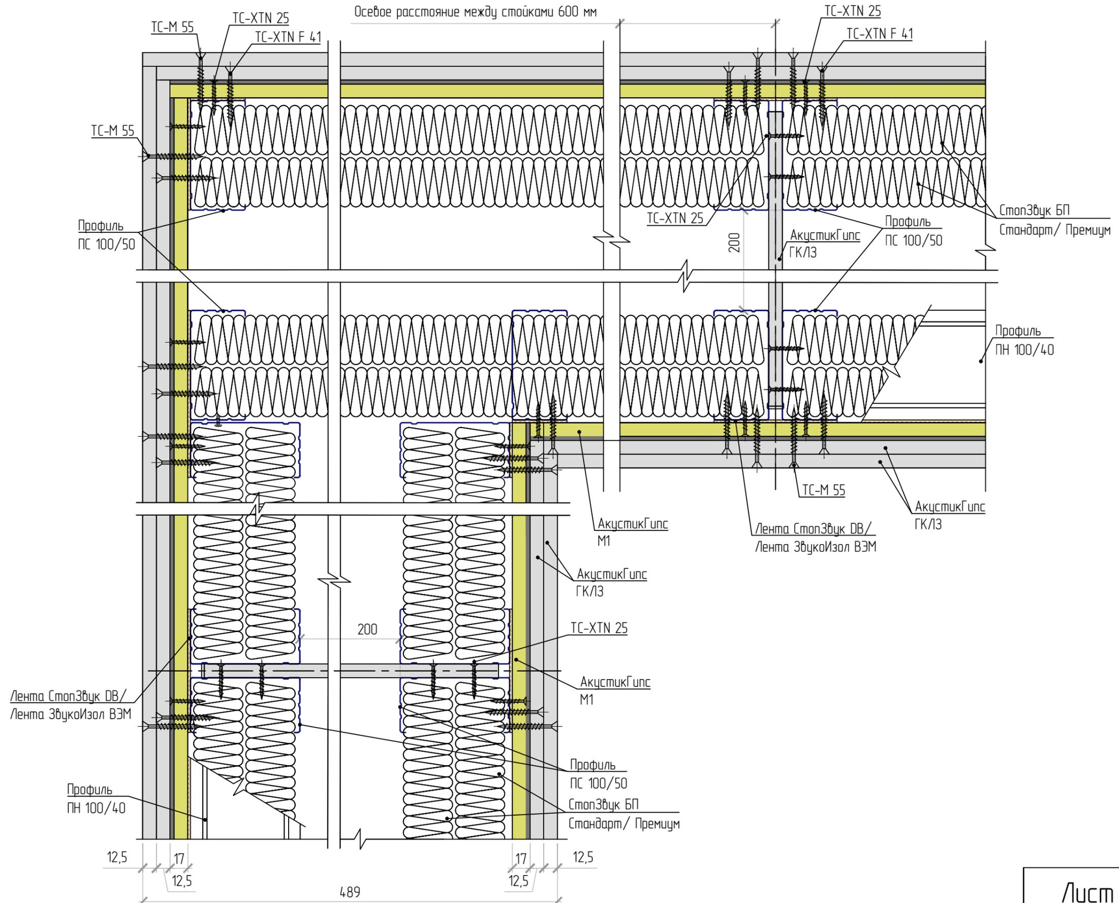
Внешний угол каркасных облицовок стен,
