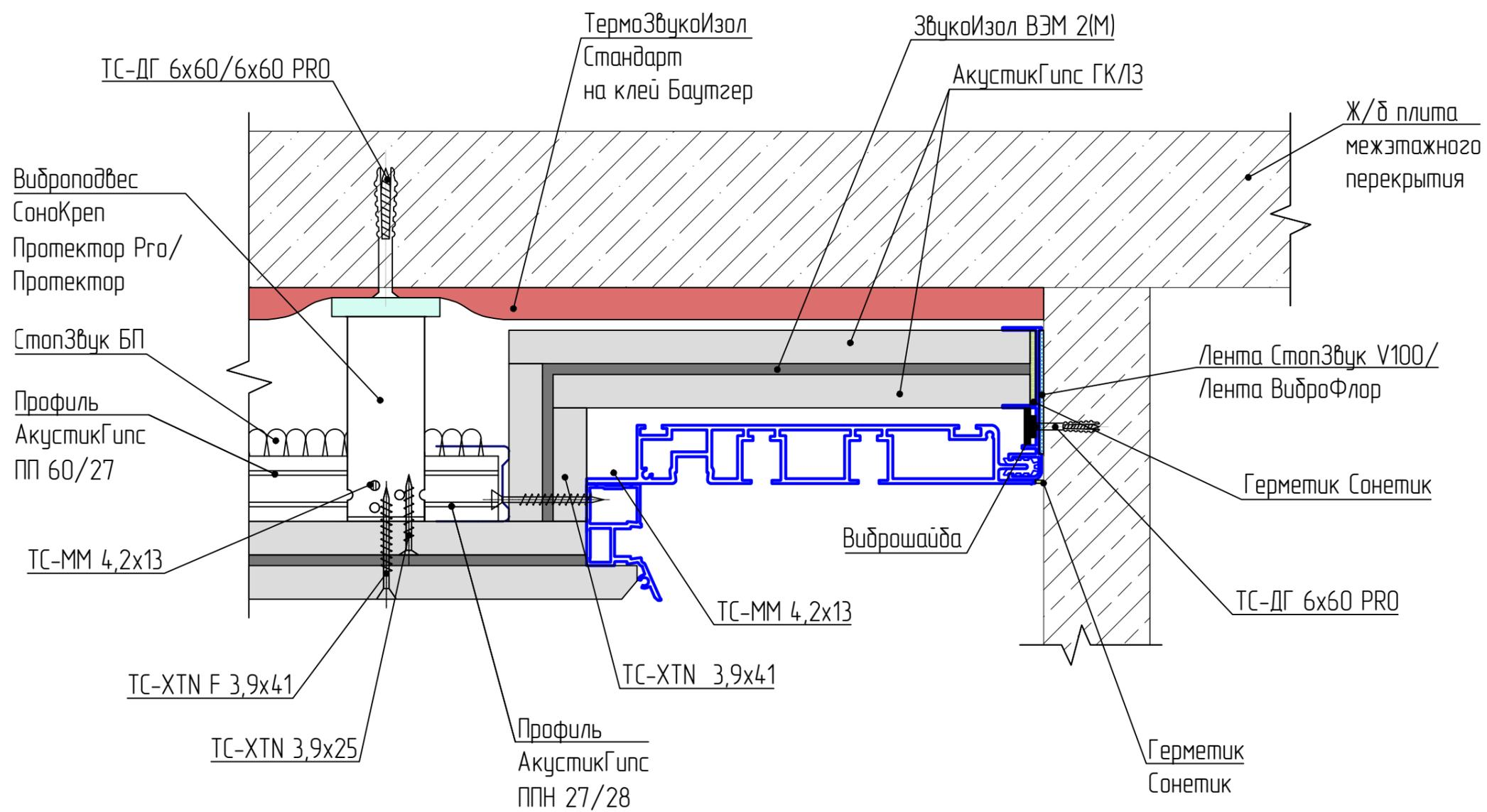
Устройство карнизного профиля шириной 140 мм и
