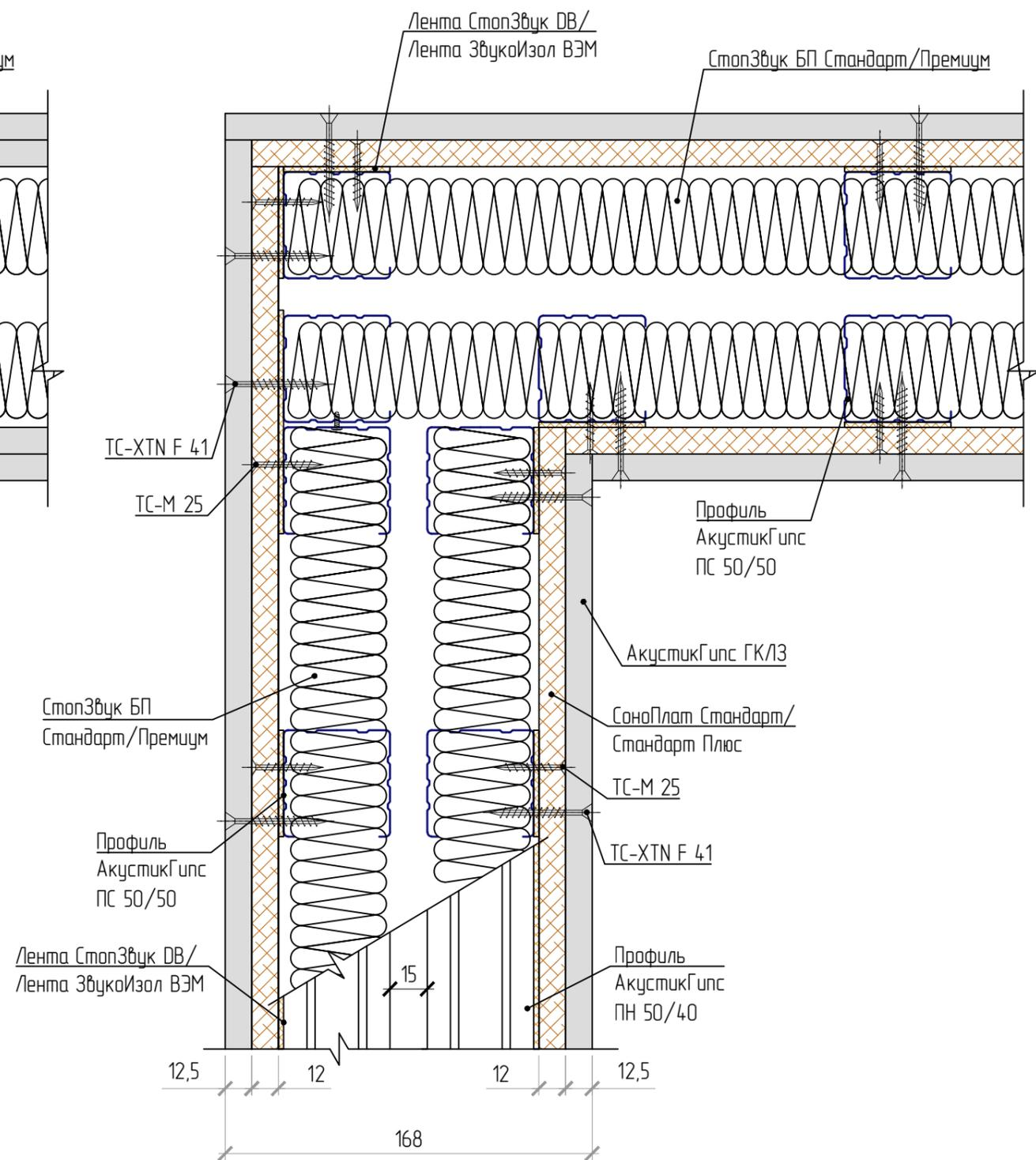
Внешний угол каркасных перегородок,
