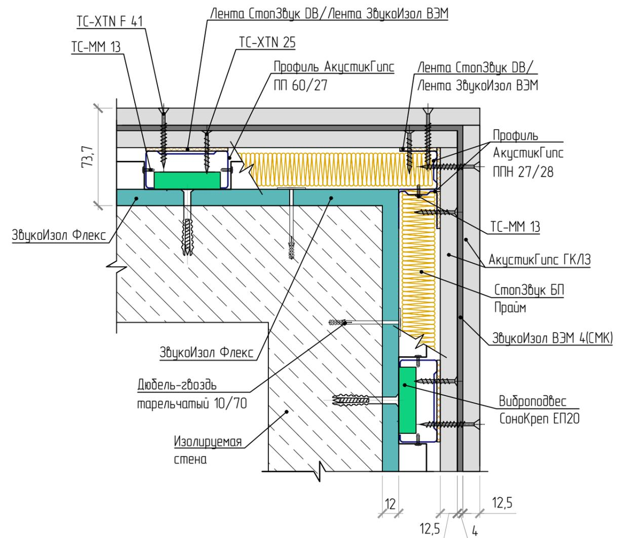
Внешний угол каркасных облицовок стен,
