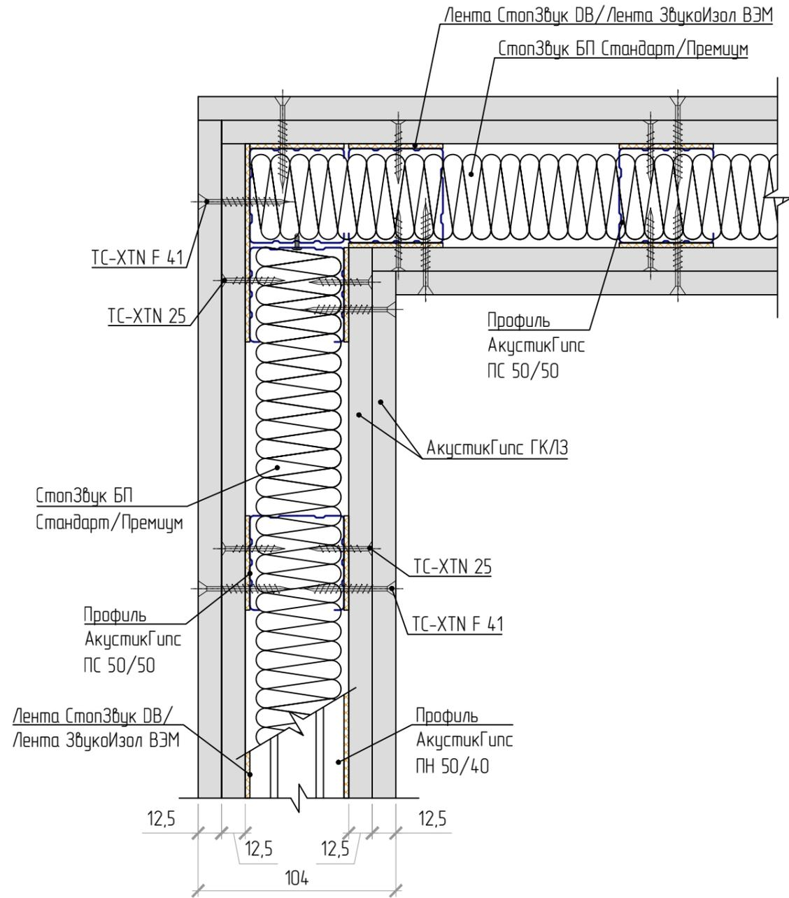
Внешний угол каркасных перегородок,
