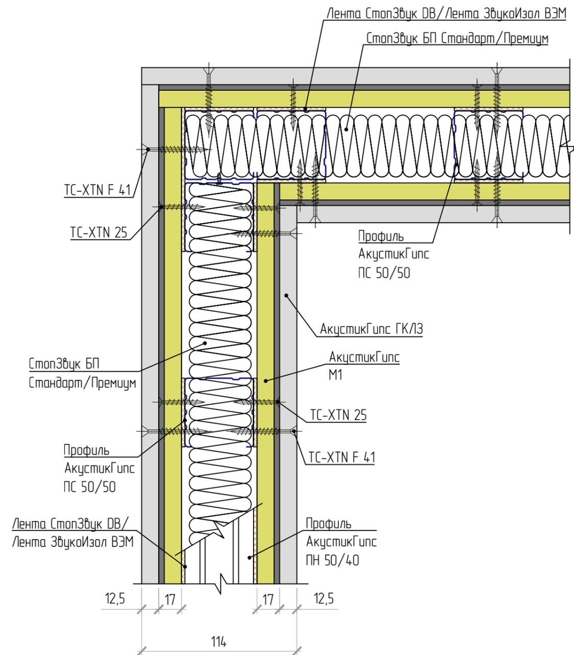
Внешний угол каркасных перегородок,
