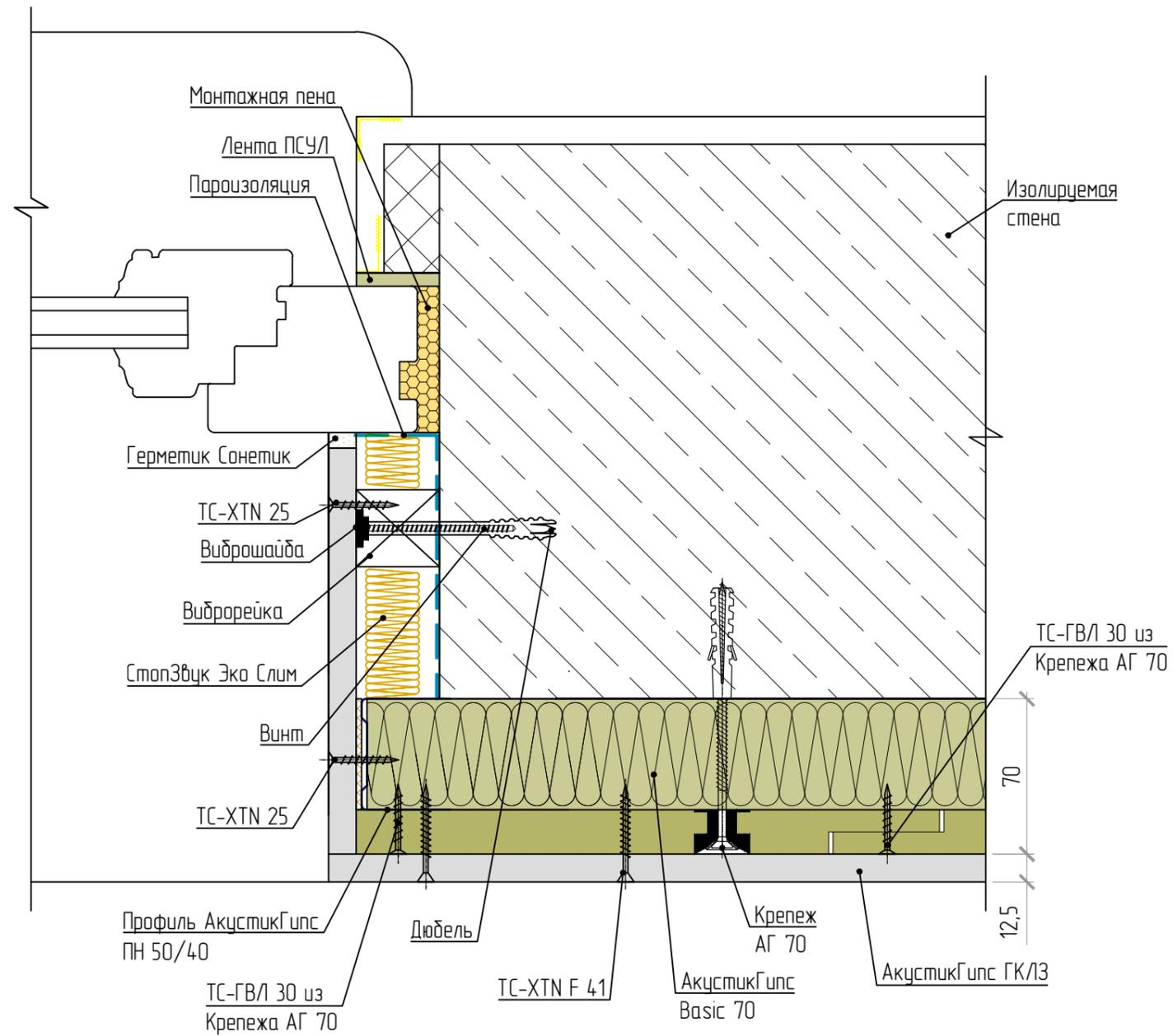
Примыкание каркасной облицовки стены к конструкции оконного блока,
