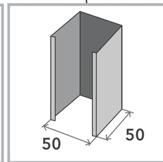
Монтируем профиль ПН через ленту СтопЗвук V100 / Виброфлор с шагом 250-300 мм. Расстояние между каркасами 15 мм. При использовании ленты Виброфлор профиль следует фиксировать через новые отверстия, просверливая их вместе с лентой. Это ускорит монтаж и исключит наматывание материала на сверло.
