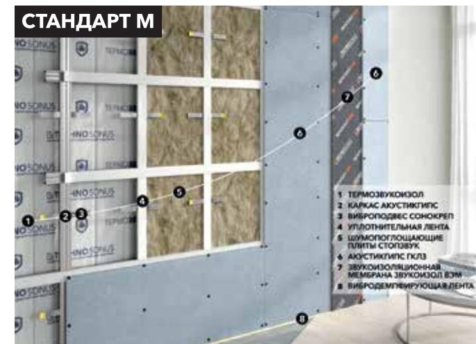
Система второго уровня звукоизоляции. Применяется в многоквартирных жилых домах повышенной комфортности, гостиницах, больницах, санаториях и т.п. Обеспечивает помещение акустическим комфортом благодаря защите от бытового воздушного шума, а для потолков – за счет значительного ослабления структурного шума (механические удары, топот и т.п.). Основным элементом системы является тонкая тяжелая панель Соноплат.
