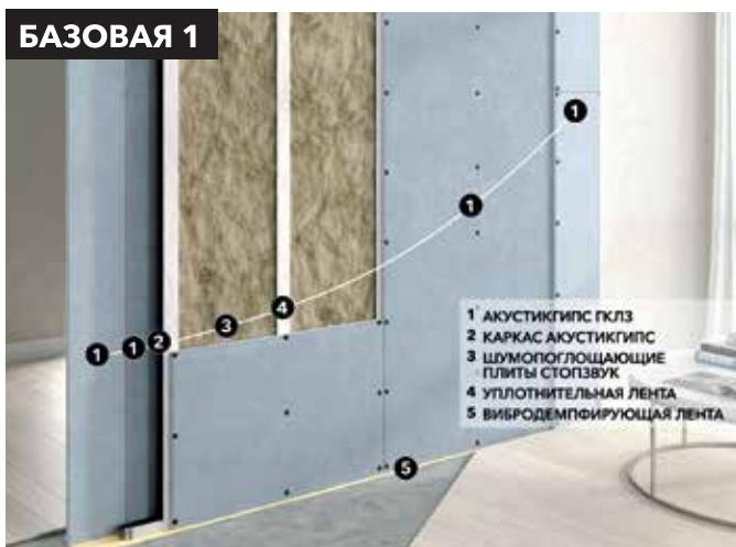
Базовая звукоизоляционная система для разделения двух помещений. Применяется в гостиницах, кабинетах, переговорных, производственных цехах и т.п. Позволяет добиться снижения бытового шума до нормативных значений, предусмотренных СП 51.13330.2011 "Защита от шума" (Актуализированная редакция СНиП 23-03-2003). Основным элементом системы являются усиленные гипсокартонные листы ГКЛЗ АкустикГипс.
