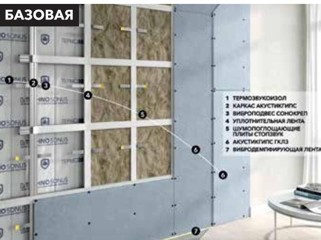
Система начального уровня звукоизоляции для стен и потолков. Рекомендуется для многоквартирных или частных жилых домов. Базовая система позволяет добиться снижения бытового шума до нормативных значений, предусмотренных СП 51.13330.2011 "Зашита от шума" (Актуализированная редакция СНиП 23-03-2003).
