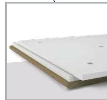
Наклеить по периметру ленту СтопЗвук V100 / Виброфлор. Ленту Виброфлор толщиной 4 мм сложить в два слоя, склеив их между собой, лента Виброфлор 6 мм монтируется в один слой. Для монтажа применяется виброакустический герметик Сонетик или клей Баутгер.
