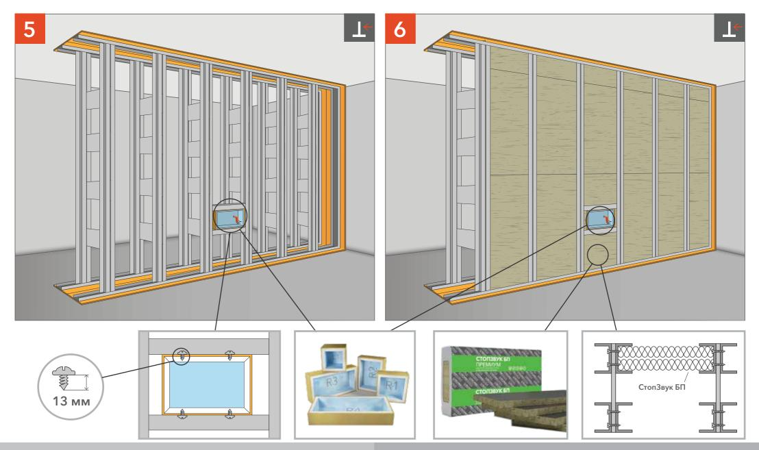
Устанавливаем подрозетник АкустикГипс Бокс в заранее подготовленный каркас из профиля.
