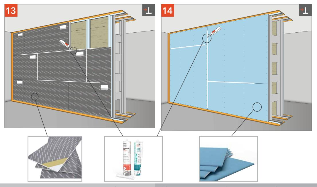
Крепим панели АкустикГипс М1, заполняя соединения виброакустическим герметиком Сонетик.
