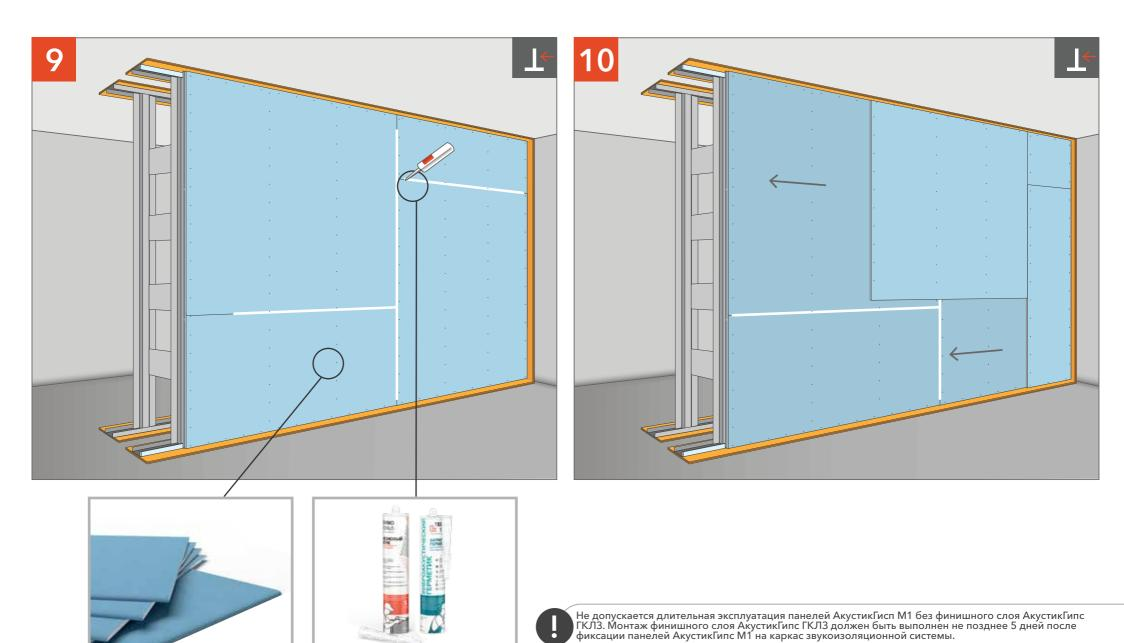
Обшиваем слоем АкустикГипс ГКЛЗ, заполняя соединения виброакустическим герметиком Сонетик.
