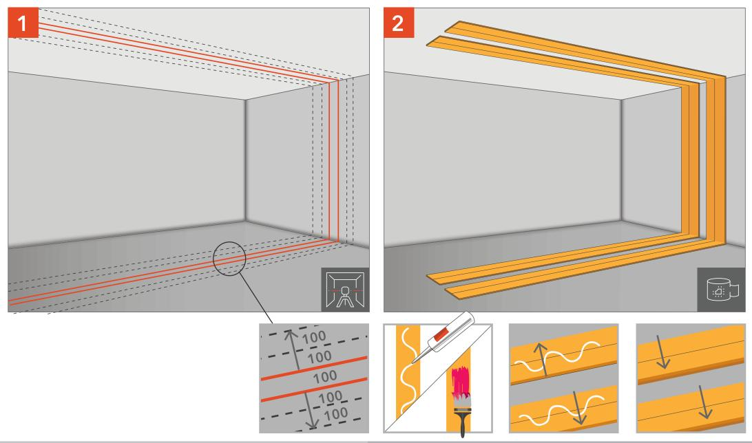
Делаем разметку осевой линии перегородки.
