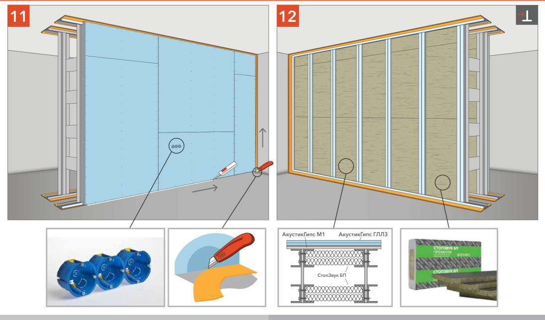
Удаляем излишки ленты СтопЗвук V100 и промазываем периметр виброакустическим герметиком Сонетик.
