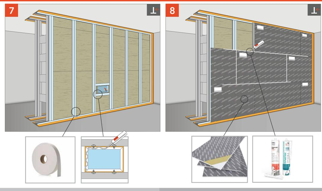
Оклеиваем каркас уплотнительной лентой. На поверхность подрозетника наносим виброакустический герметик Сонетик.
