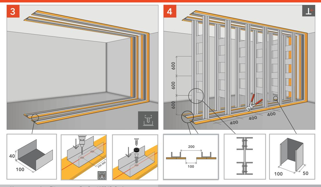
Монтируем профиль ПН через ленту СтопЗвук V100 / Виброфлор с шагом 250-300 мм. Расстояние между каркасами 140 мм. При использовании ленты Виброфлор профиль следует фиксировать через новые отверстия, просверливая их вместе с лентой. Это ускорит монтаж и исключит наматывание материала на сверло.
