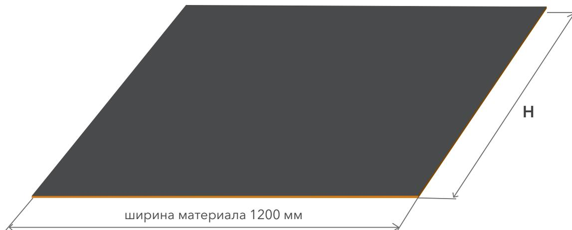
При раскройке материала для круглой трубы учитываем толщину мембраны Звукоизол ВЭМ.
