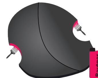
Наносим клей Баутгер на внутренний диаметр.
