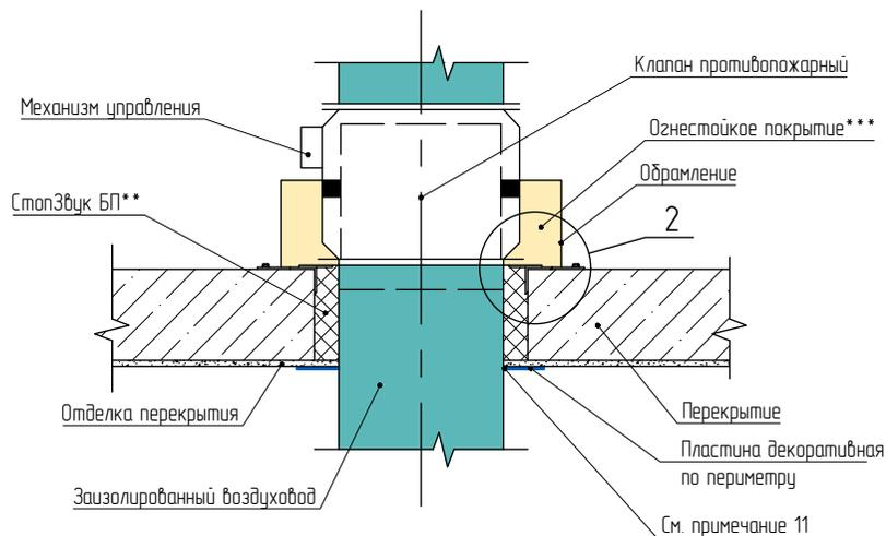
Узел прохода воздуховода через стену, перегородку
