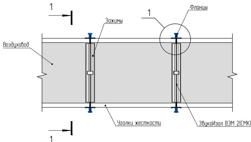
Узел 1. Схема оклеивания защищаемых поверхностей воздуховода
