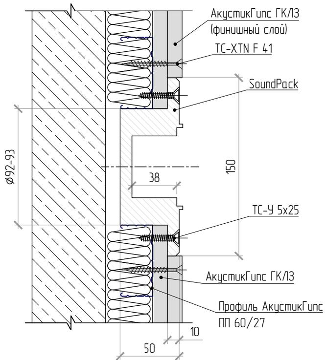
Схема устройства потолочных светильников
