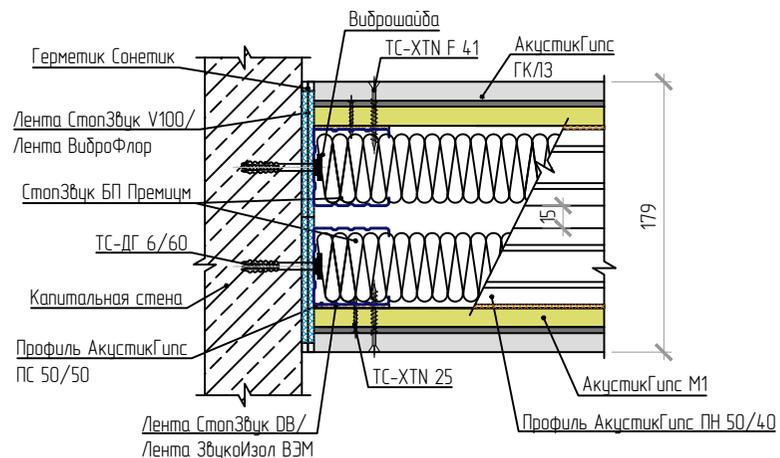
Примыкание перегородок под углом 90°
