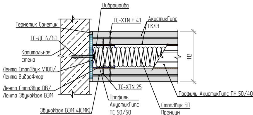
Примыкание перегородок под углом 90°
