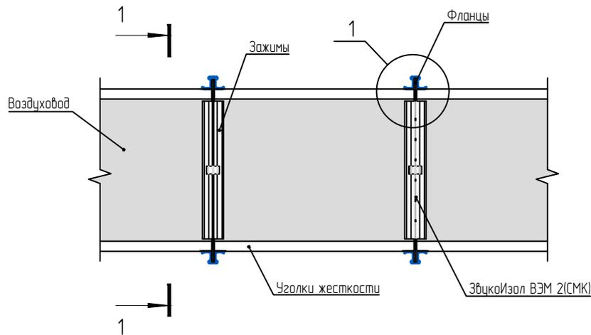
Узел 1. Схема оклеивания защищаемых поверхностей воздуховода
