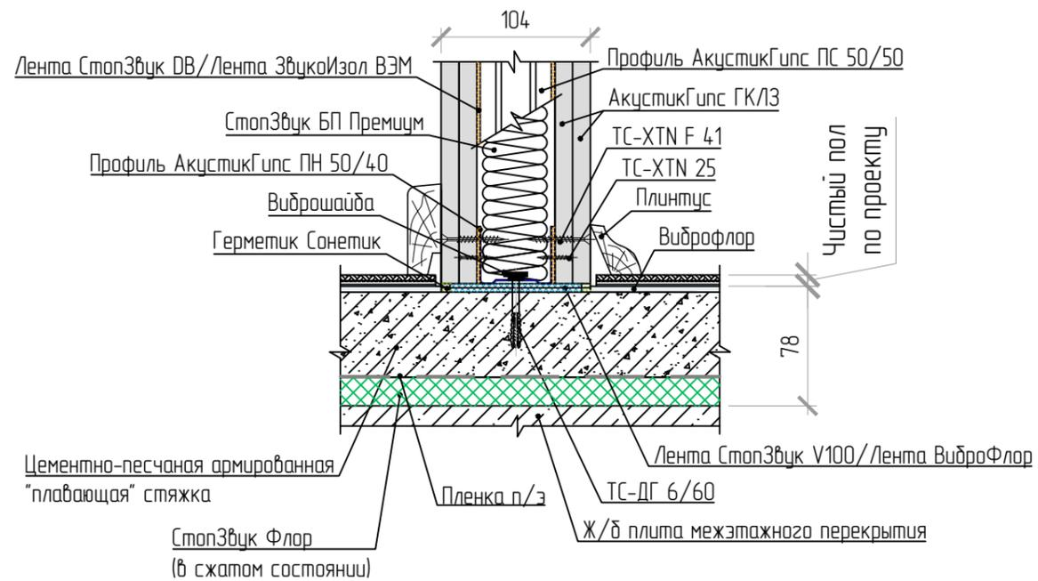
Примыкание пола к облицовке стены ТС-2.1
