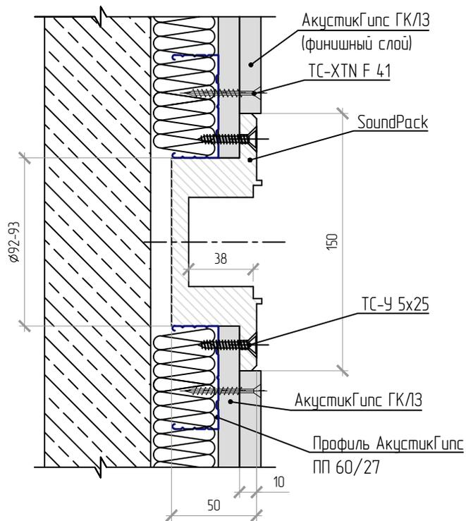
Схема устройства потолочных светильников
