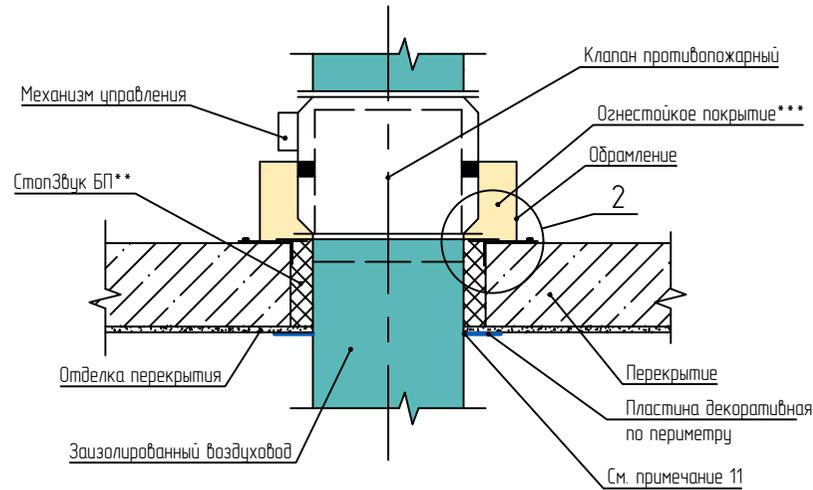
Узел прохода воздуховода через стену, перегородку
