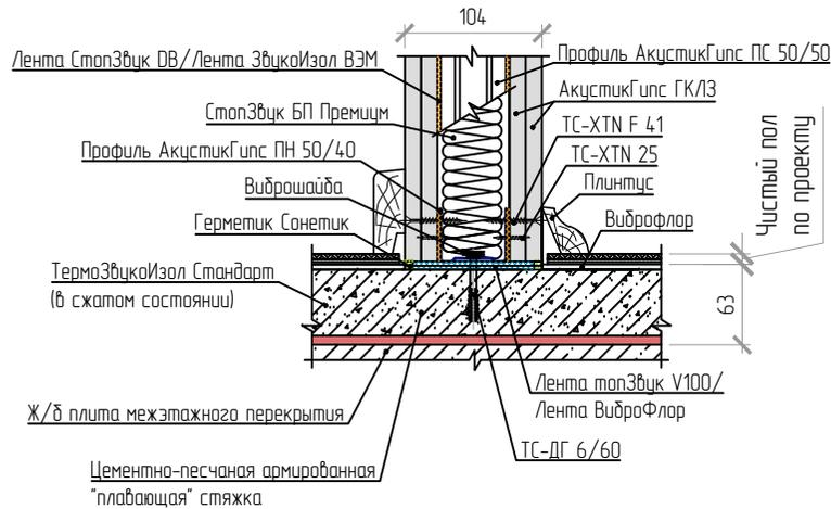
Примыкание пола к облицовке стены ТС-2.1
