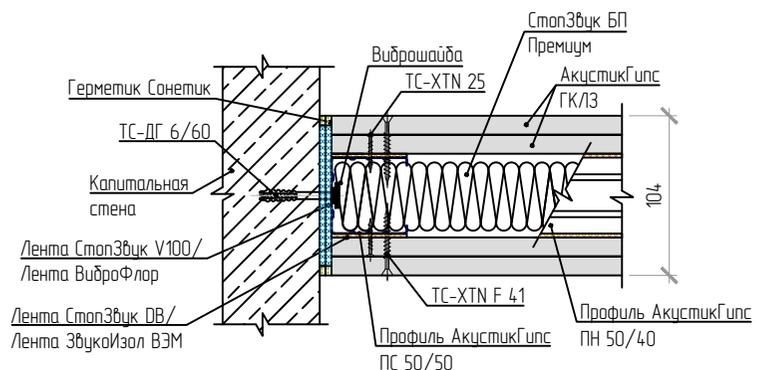
Примыкание перегородок под углом 90°
