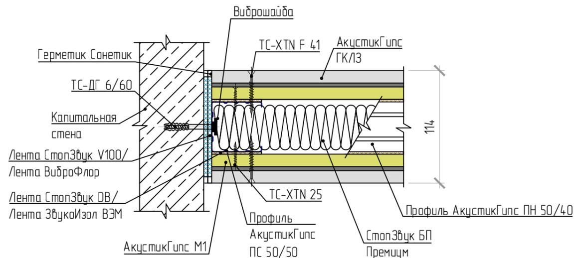
Примыкание перегородок под углом 90°
