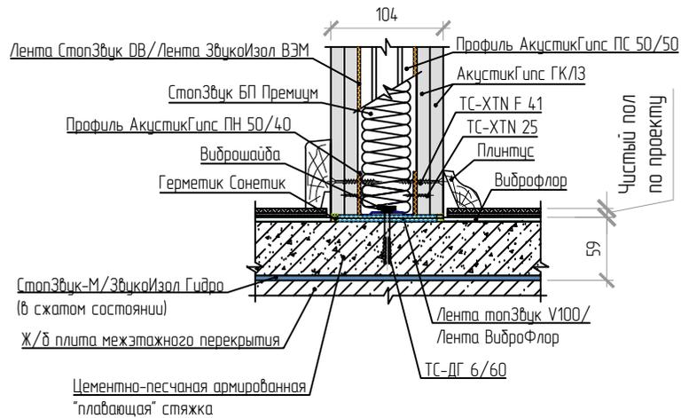
Примыкание пола к облицовке стены ТС-2.1
