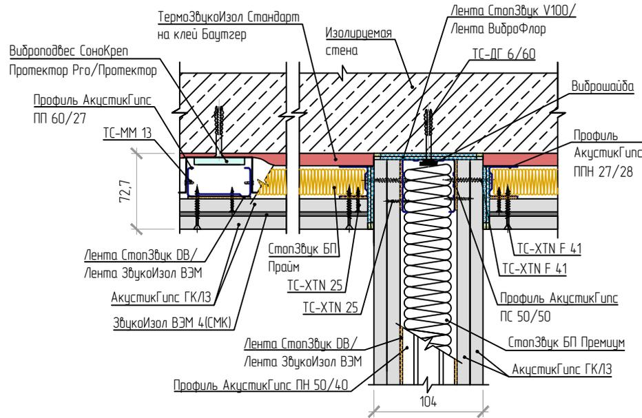
Примыкание облицовки стены к "плавающей" стяжке пола и к плите межэтажного перекрытия в уровне потолка
