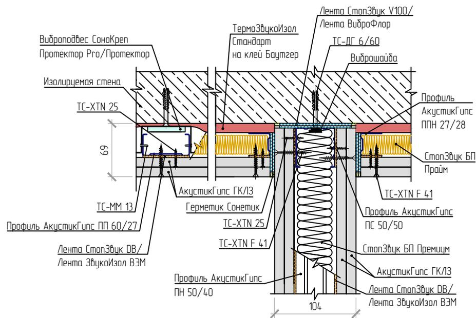
Примыкание облицовки стены к "плавающей" стяжке пола и к плите межэтажного перекрытия в уровне потолка
