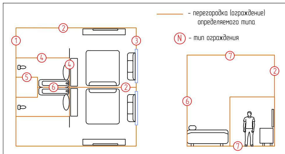
Красными кружками обозначены номера разных типов ограждения межномерных и внутриномерных перегородки перекрытий. Так, например перегородка типа 2 может быть выполнена конструктивно разной и иметь при этом разные значения критического параметра звукоизоляции воздушного шума  $R_w$  или, как для перекрытия по типу 7, сразу для двух параметров –  $R_w$  и критического параметра по ударному шуму  $L_{p,w}$ .
