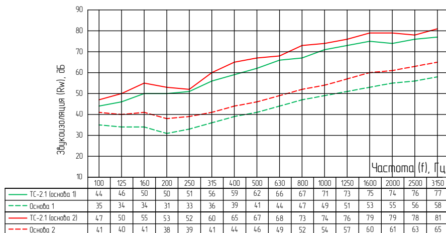
Частотные характеристики изоляции воздушного шума, R_w(f)
