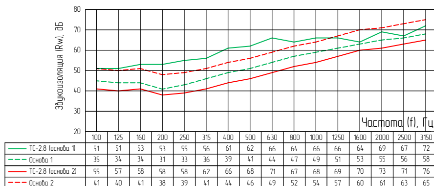
Частотные характеристики изоляции воздушного шума, R_w(f)
