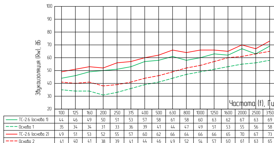
Частотные характеристики изоляции воздушного шума, R_w(f)
