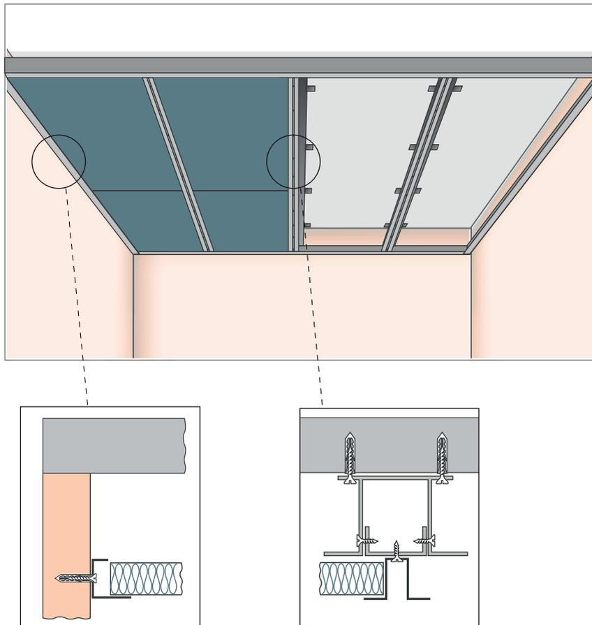
6 Фиксируем направляющий профиль L в углах на вытяжные заклепки.
