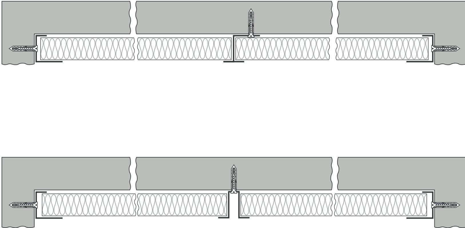
2 Схема монтажа на потолок на металлическом профиле.
