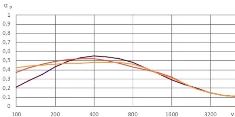
График 1 – с относом 50 мм и заполнением 50 мм СтопЗвук БП Стандарт
