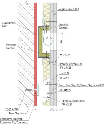
Устройство звукоизоляции розеток в бескаркасной системе, тип ТС-2.6 (Слим П)
