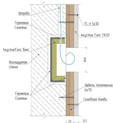
Устройство звукоизоляции розеток в бескаркасной системе, тип ТС-2.7 (Слим А1)
