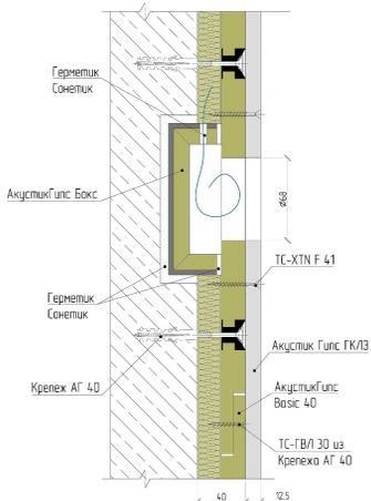
Устройство звукоизоляции розеток в бескаркасной системе, тип ТС-2.8 (Слим А2)
