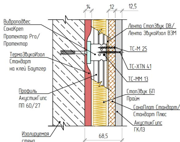
В состав системы не включены фиксирующие крепежные элементы для виброподвесов. Фиксирующие крепежные элементы подбираются самостоятельно в зависимости от состава основания стен, функциональности помещения и требований к безопасности.
