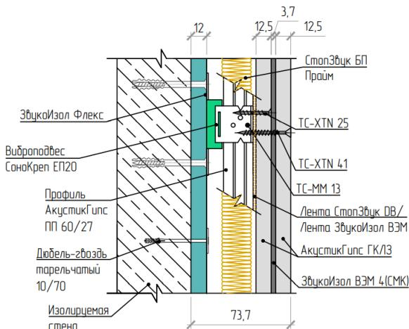
В состав системы не включены фиксирующие крепежные элементы для виброподвесов. Фиксирующие крепежные элементы подбираются самостоятельно в зависимости от состава основания стен, функциональности помещения и требований к безопасности.
